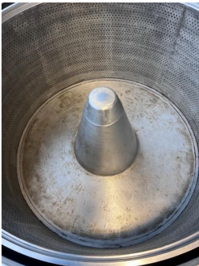
4- Cesto e tampa do extrator centrífugo.
